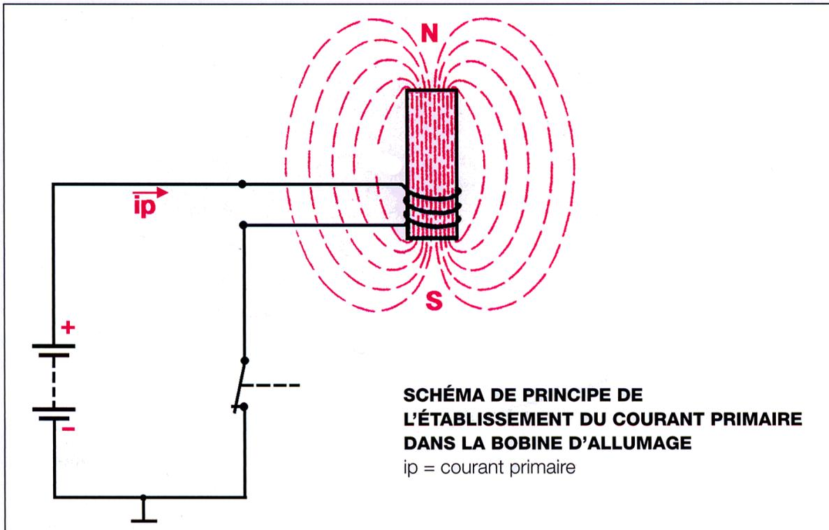
La bobine va emmagasiner de l'énergie, mais le « remplissage magnétique » n'est pas instantanée et dépend de l'établissement du courant primaire.
