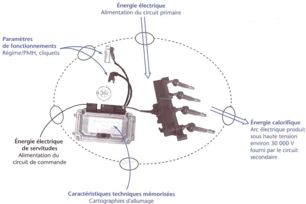
Le système d'allumage fournit l'énergie calorifique nécessaire à l'inflammation du mélange en produisant un arc électrique sous haute tension.
