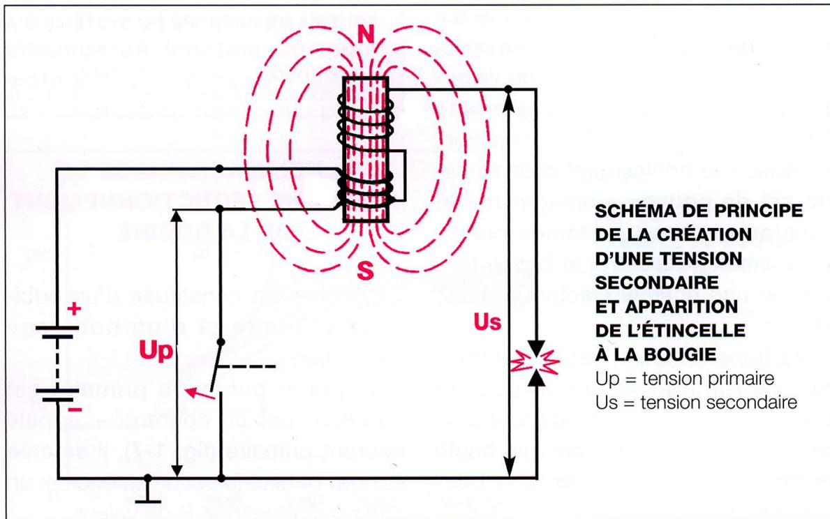
La coupure brutale du courant primaire  $I_p$  entraîne la création, dans le bobinage secondaire, d'une haute tension..... (appelée tension secondaire) qui va être transmise à la bougie. Cette haute tension est fonction de la tension primaire dans le rapport des caractéristiques des bobinages.
