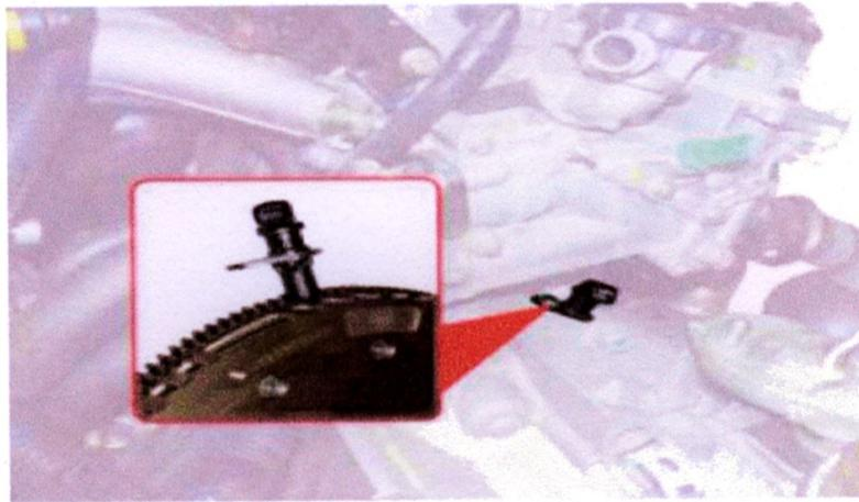
La mesure de référence angulaire et de la vitesse de rotation du moteur s'effectue par un capteur passif fixé sur le carter d'embrayage et placé en regard d'une couronne de 58 dents montée sur le.....
