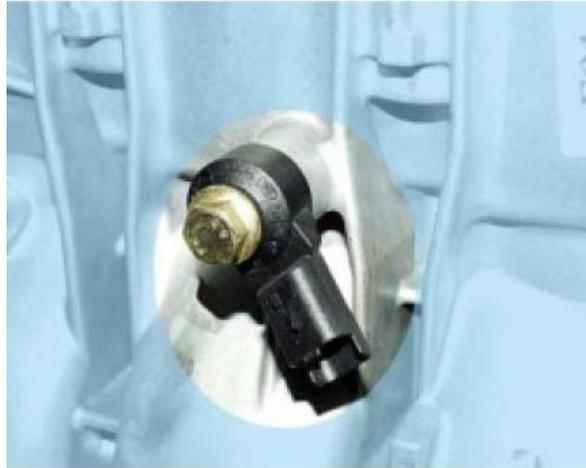
Il..... et..... en signaux électriques les vibrations caractéristiques d'une combustion détonante trop forte, qui peut engendrer une surchauffe des cylindres (points de chauffe).
