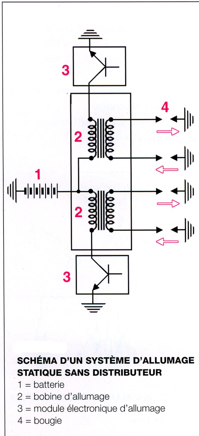
**e. Système d'allumage jumo statique avec module extérieur au calculateur d'injection**
