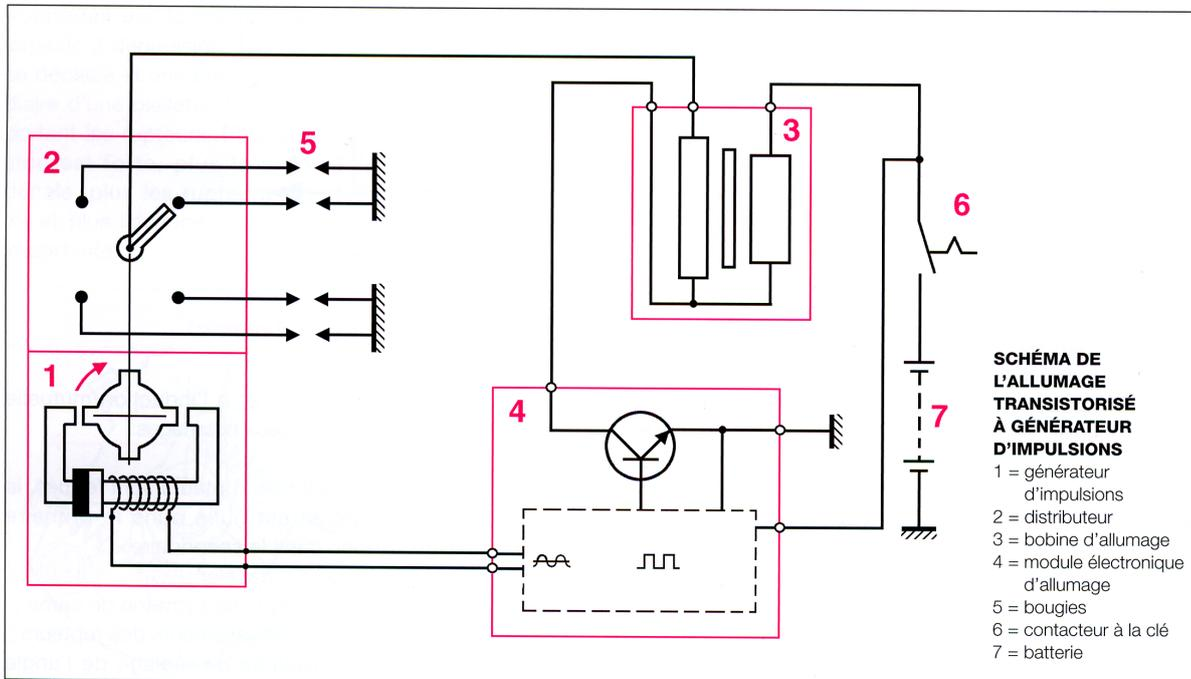
On retrouve les mêmes fonctions que précédemment. La seule différence se situe au niveau du..... qui est remplacé par un capteur fixe en regard d'une cible rotative liée à l'axe de l'..... Le signal qui apparaît est exploité par un boîtier électronique pour déclencher le..... de la bobine.
